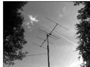
Kannen kuva: Triaxin 5-el. yagi, jolla kuulee intialaisia FM-asemia. Huomaa kätevä kahva, josta antennia on helppo siirrellä. (Foto: Markku Sollo)
